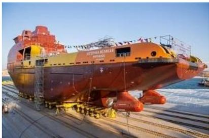
Le MPSV Ice Class *Katerina Velikaya* a été conçu pour des opérations de ravitaillement de plates-formes de forage offshore, pour fournir une assistance de déglacage et le remorquage de navires. D'une longueur de 106 m, d'une largeur de 22 m et dotés de deux propulseurs orientables d'une capacité de 7,5 MW chacun, il est capable de progresser dans 1,5 m de glaces épaisses. Il est armé par un équipage de 49 personnes. Sources : [Neftgaz.ru](http://Neftgaz.ru) ; [Portnews.ru](http://Portnews.ru)
