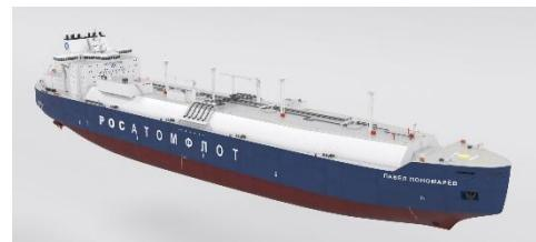
propose d'utiliser des lignes d'arbre classique en attendant de maîtriser la propulsion azimutale avec des moteurs de production d'énergie dual fuel ([Paluba.media.ru](http://Paluba.media.ru), 02 novembre 2025).
